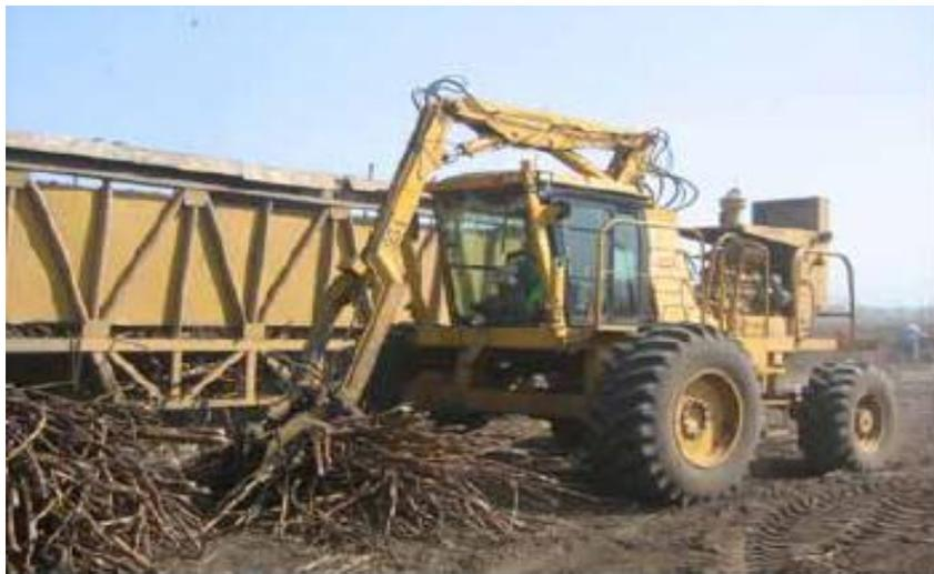
*Ilustración 3.4 Máquina alzadora Cameco modelo SP2254 alzando caña*
