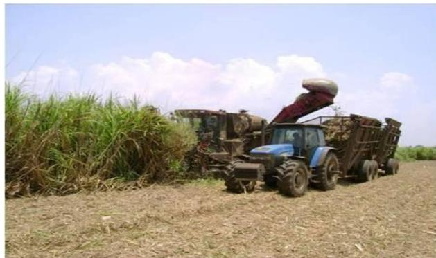
*Ilustración 3.1 Cosecha mecanizada, cosechadora y autovolteo trabajando en paralelo*
