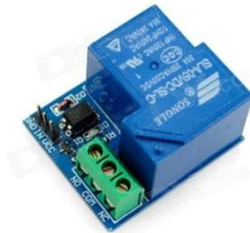
*Fig. 6: Relé Opto-aislado 5V/30A.*
