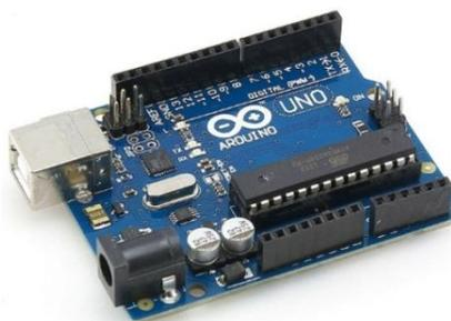
Fig. 9: Placa Arduino UNO R3.
