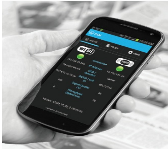
Figura 7.1.20 Foto de un teléfono con un administrador de Conexiones SAM (Smart Access Manager) desarrollado por InterDigital para dispositivos iOS y Android Extraído de [InterDigital SAM Data Sheet]
