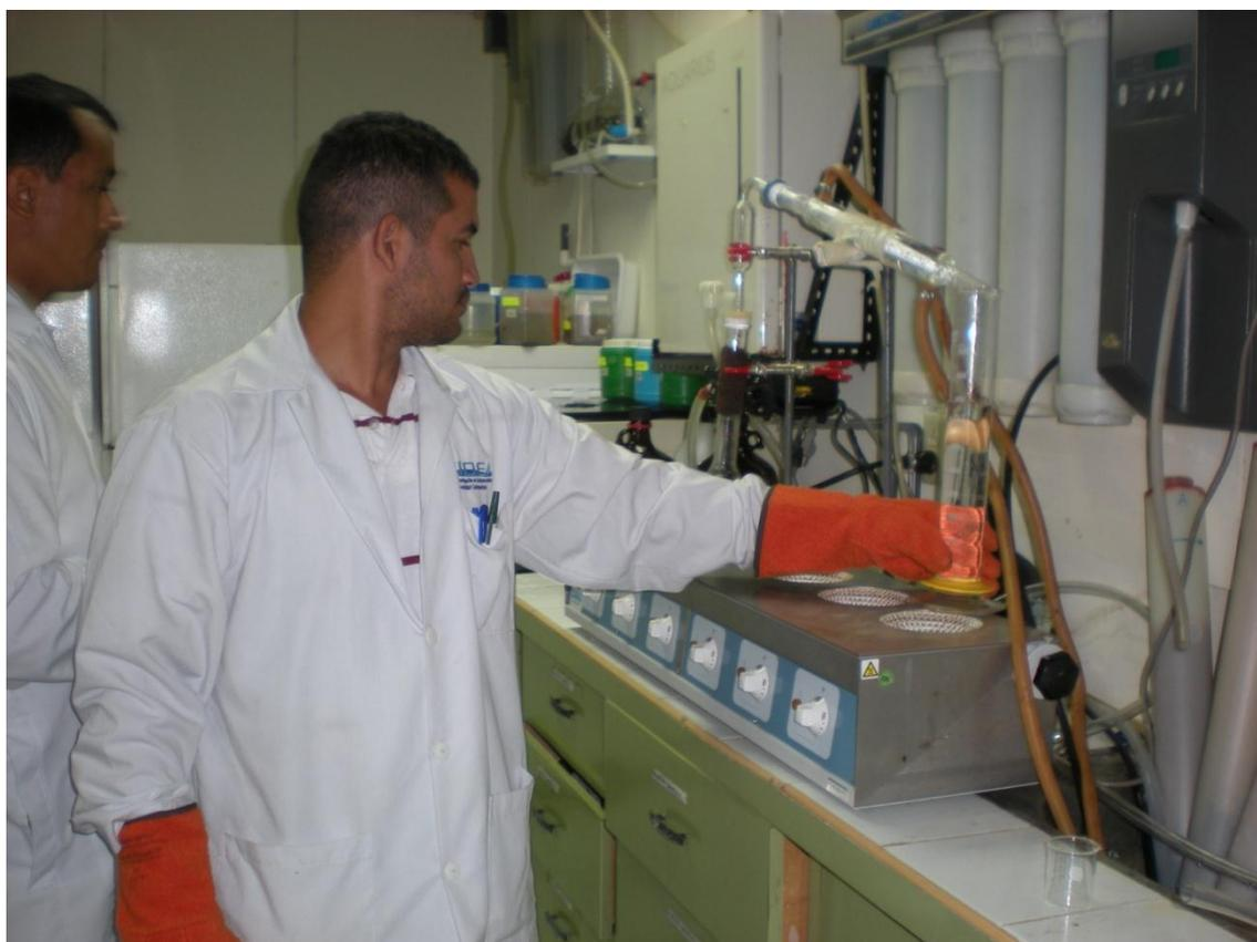
**Figura 10.12** Ajustando la probeta de salida en el sistema de destilación
