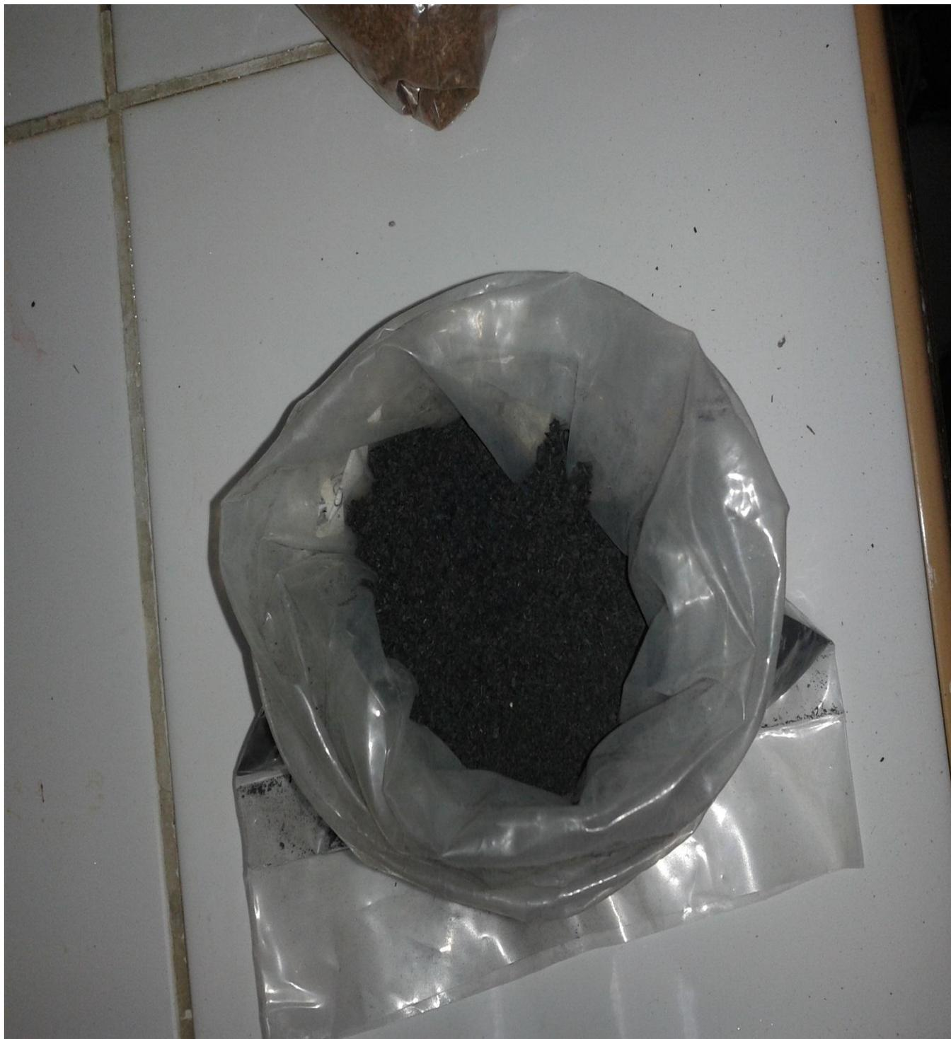
**Figura 10.15** Carbón activado de vaina de malinche (CAP).
