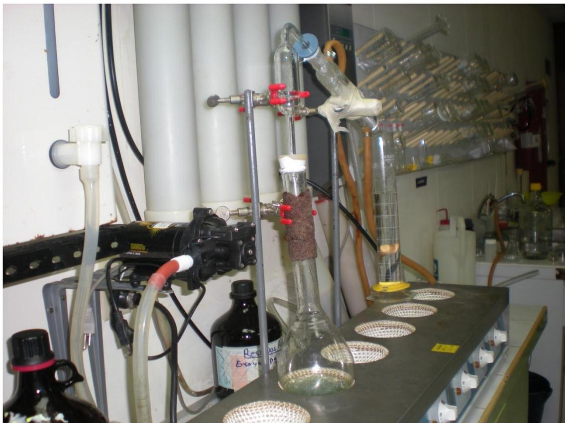
Figura 10.11 Sistema de destilación
