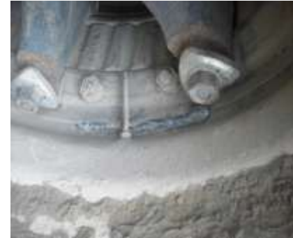
Fig. 10. Rin soldado por falta de repuestos en stock
