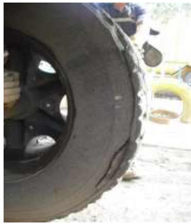
Fig. 11. Llanta en mal estado no fue cambiada.
