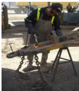
Fig. 12. Sustitución de una argolla de remolque
