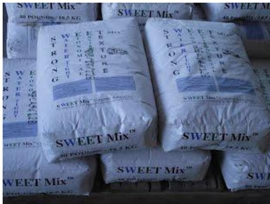
Primero mezclen los materiales, mientras esta en rotación la mezcladora, rociar el Aditivo Sweet Mix (1%-2% libras del cemento) a los ingredientes (materiales) cemento, arena, agregado, etc., que ya están mezclados.
