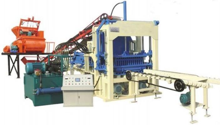
El sistema de vibración contiene no sólo vibración de plataforma pero también moldes vibración, por lo que el producto de la misma es muy alta en compacidad y corta en el ciclo de molde. La alimentación de la máquina
