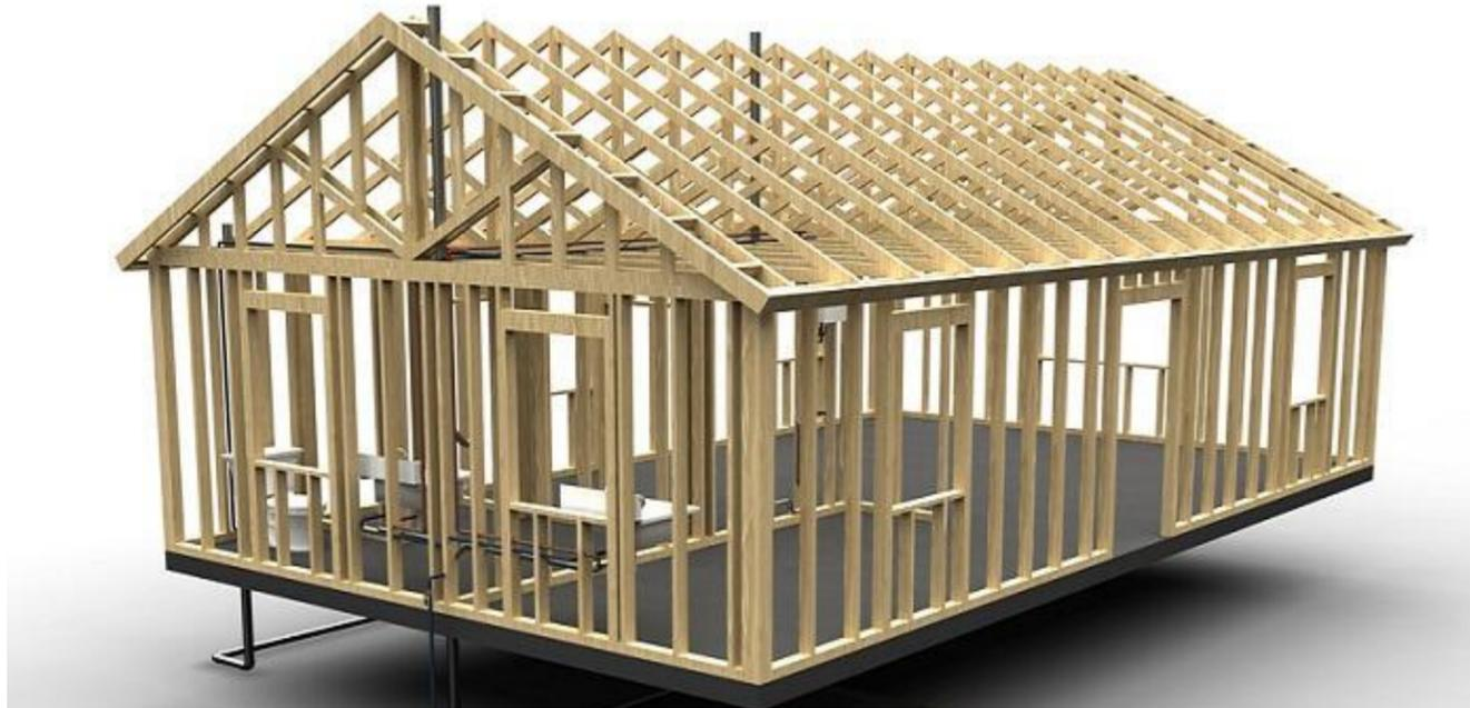
IMAGEN 09. ILUSTRACIÓN DE VIVIENDA PREFABRICADA CON SISTEMA WOOD FRAME
