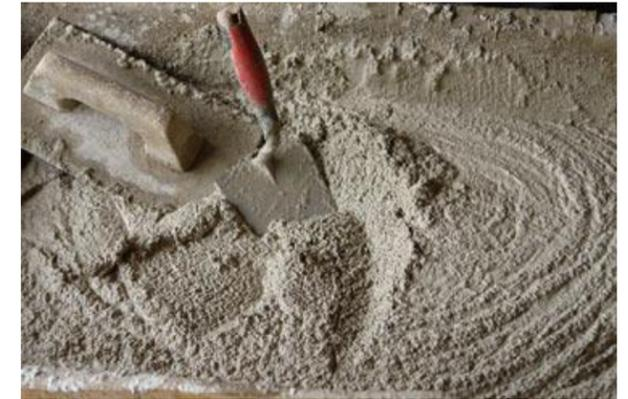
IMAGEN 03. MEZCLA DE MORTERO A BASE DE CEMENTO, GRABA, ARENA Y AGUA
