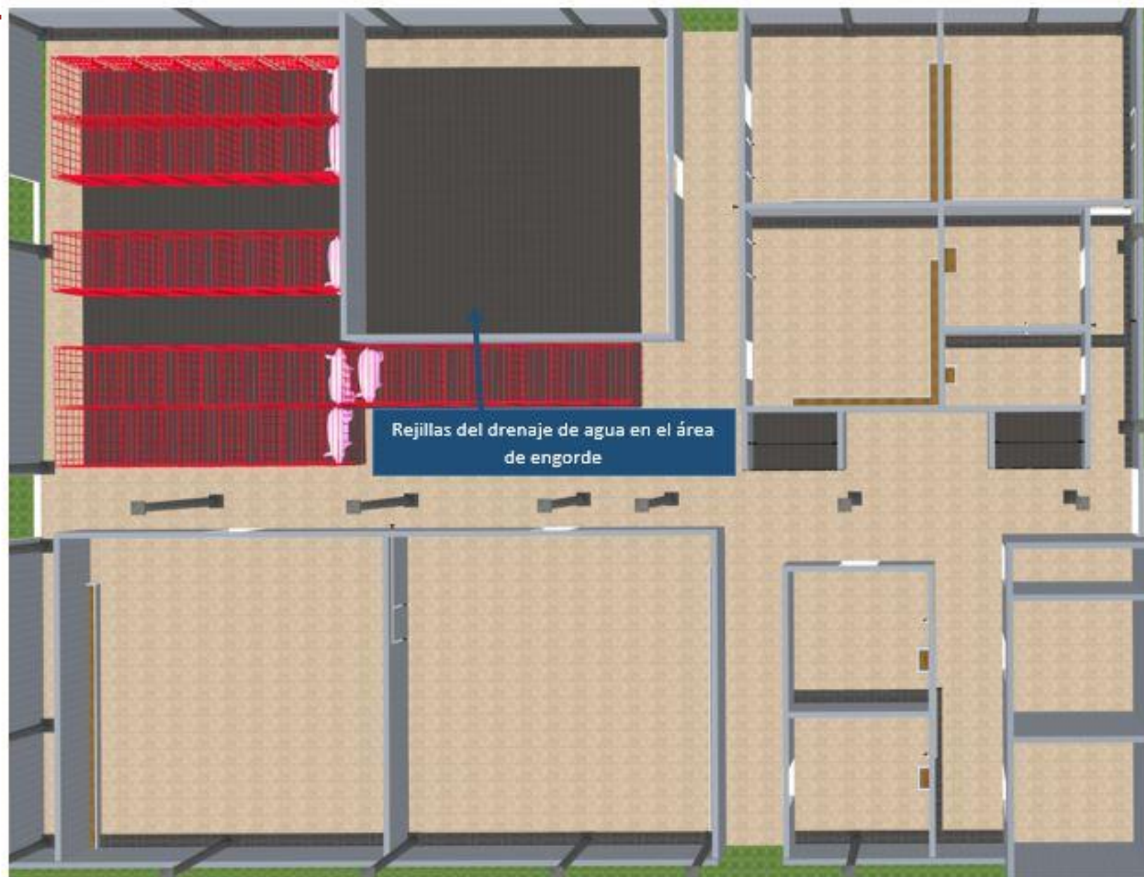
Fig. 65: Vista superior del suelo de concreto y las rejillas de desagüe para la Cooperativa Fe y Revolución
