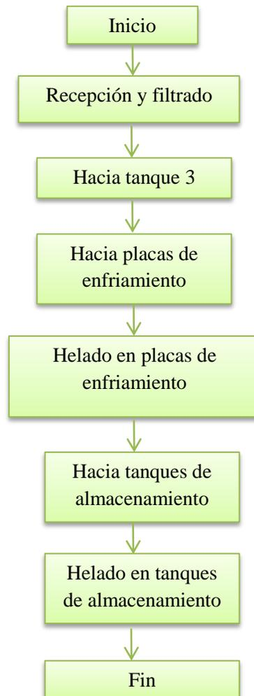
Diagrama 1: Diagrama de bloques básico del proceso de acopio lácteo.
