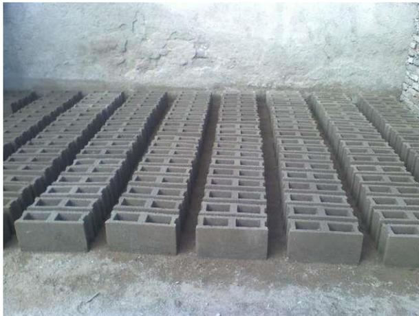
**Figura 10. Colocación de los bloques para el curado**
