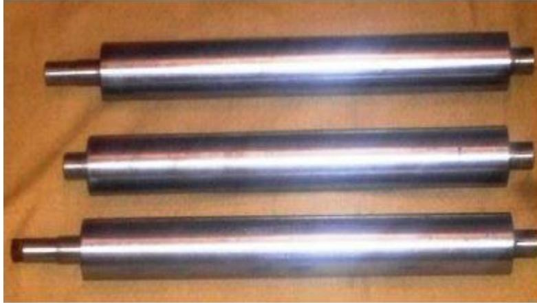
Figura 42. Eje de mesa vibratoria
