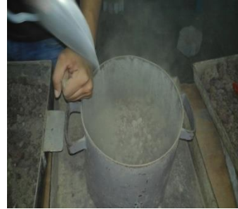
Foto No. 4. Determinación del pvss con molde cilíndrico
