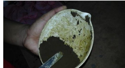
Foto No. 2. Ensayo para encontrar el LL del suelo
