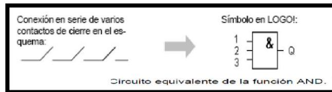
Fig. 39 Circuito equivalente de la función AND.
