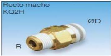
Recto macho KQ2H<br>R<br>ØD                                           | Racor recto para conexión neumática de actuadores y válvulas de paso y reguladoras de rosca M 5 y para diámetro de manguera de 6mm. |                                                                                       |
