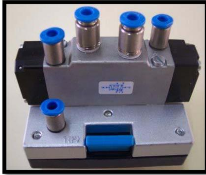
Figura 19. Foto de una válvula distribidora 5/2 NEUMÁTICA.
