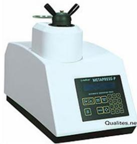
Figura No. 36: Incluidora Metalográfica.
