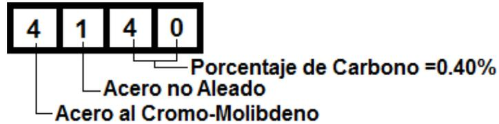
Figura No 44. Composición y Clasificación del Acero Aleado 4140. Norma SAE.
