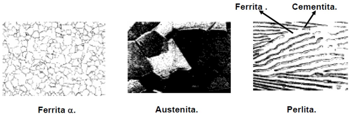
Figura No. 134: Estructuras en la que se aprecian las diferentes fases en equilibrio del acero.
