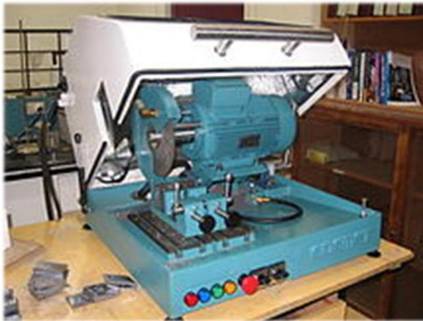
Figura No. 37: Cortadora Metalográfica.
