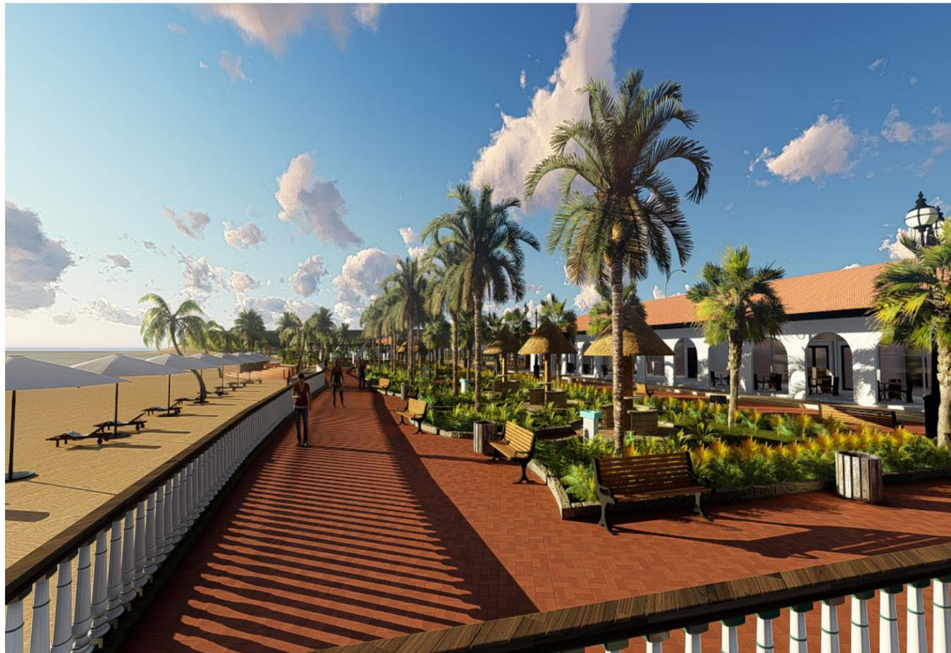
En este espacio público se propone el tratamiento de pisos tipo baldosa con colorante rojo y un acabado antiderrapante fabricado con concreto, en el momento del llenado se le dará la textura haciéndole ver como si fuera prefabricado, pero este será hecho en el campo, teniendo un acabado de piso tradicional.
