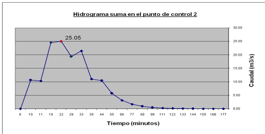
**Caudal de Diseño Transitado  $Q= 25.05 \text{ m}^3/\text{s}$**
