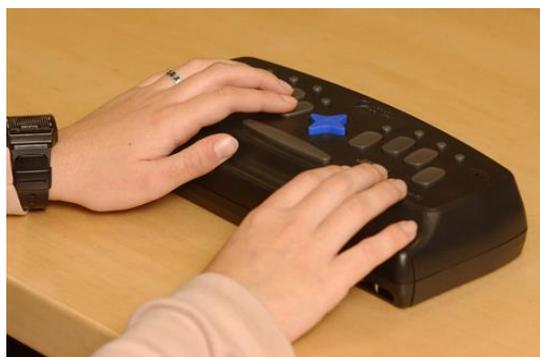
*Figura 8 Teclado Braille Electrónico*
