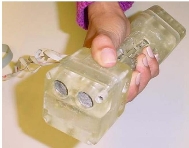
*Figura 18 Dispositivo de retroalimentación táctil de mano*
