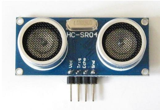
*Figura 33 Empaquetado del sensor HC-SR04*
