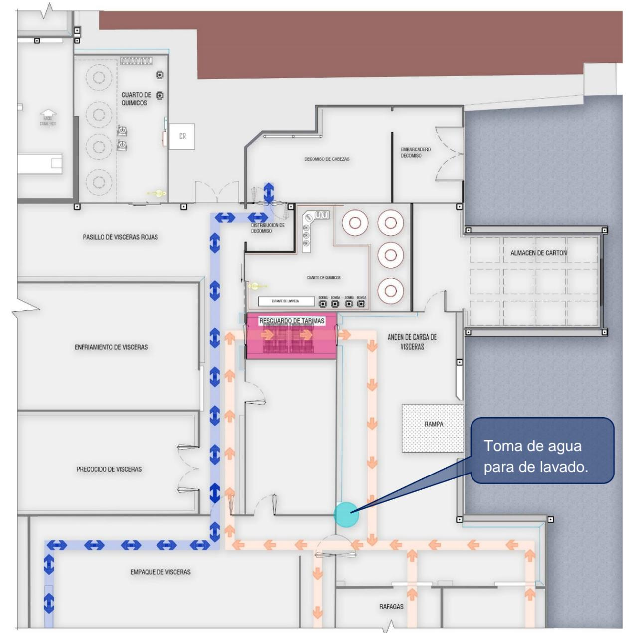
Ilustración 53. Esquema de nuevo flujo de circulación.
