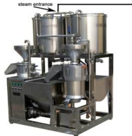
Ilustración 26. Línea de producción de leche de soja
