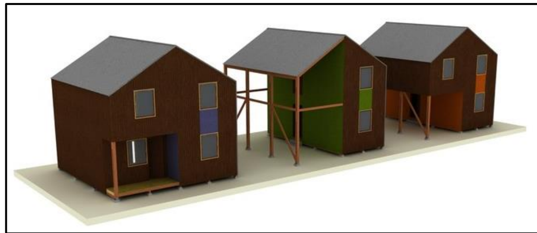
Imagen N°100. Proyecciones de viviendas progresivas en altura.
