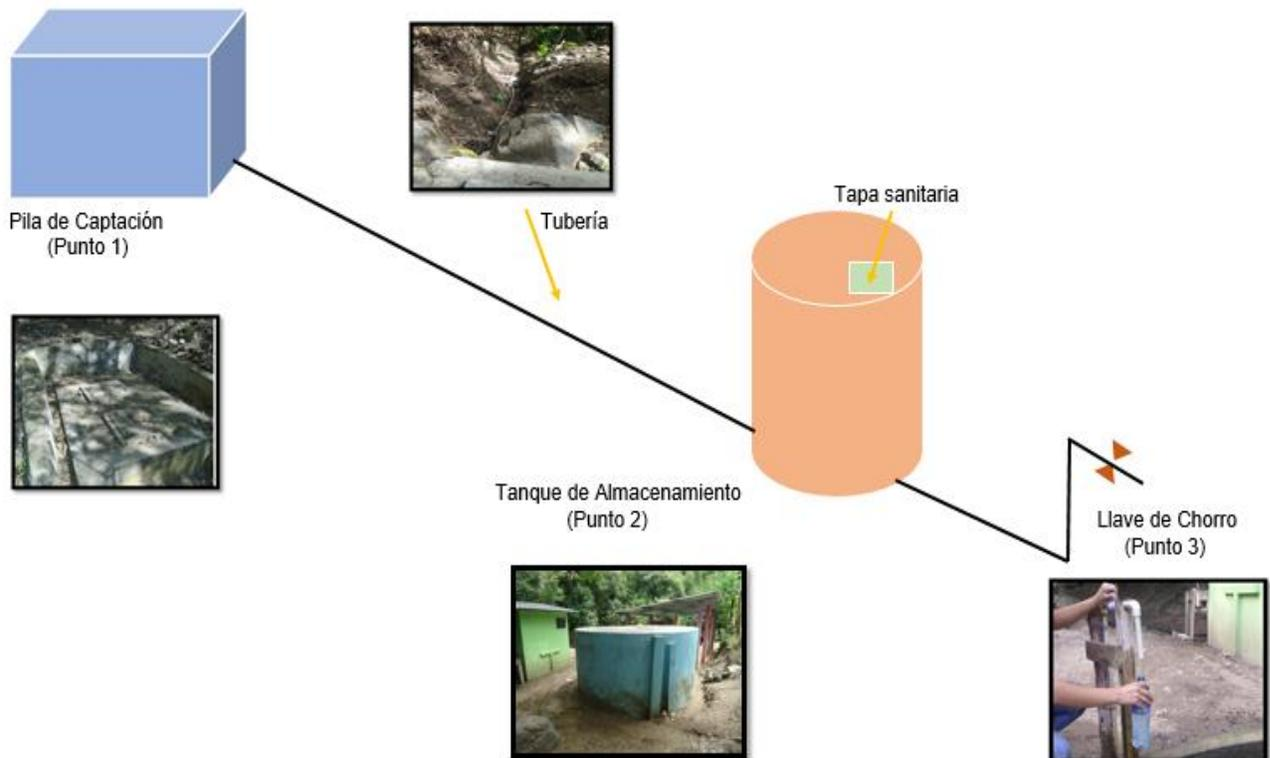
Figura 15. Esquema representativo de los componentes del sistema de abastecimiento de agua de la comunidad El Cacao.
