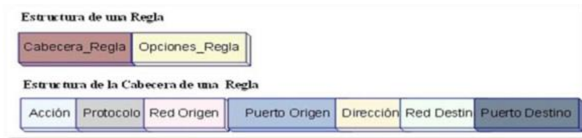
Ilustración 5 Estructura Reglas Snort. Fuente Snortudenaar
