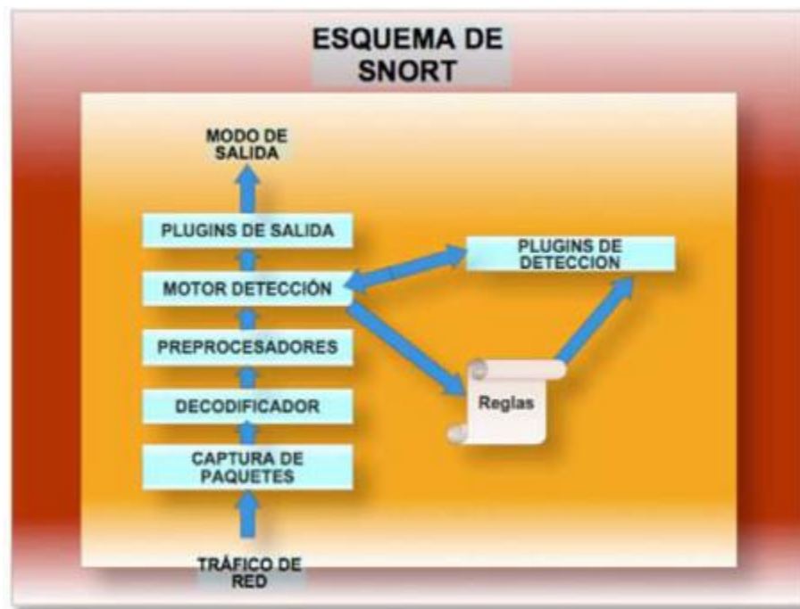
Ilustración 4 Esquema de SNORT. Fuente: Snortudenaar
