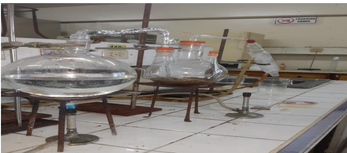
Figura 10.2 Arrastre con vapor de agua
