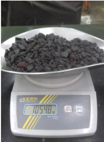
Imagen 14 (izq.) Pesaje de la muestra en condición saturada superficialmente seca (SSS)
