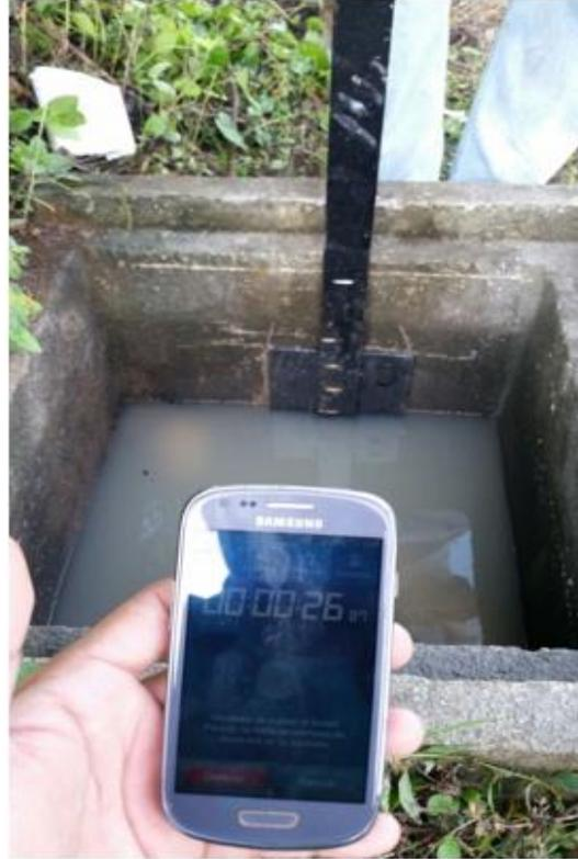
*C.5. Toma de muestras de aguas por el método de muestra compuesta. A la izquierda el agua ya tratada (salida) y a la derecha el agua sin tratar (entrada)*
