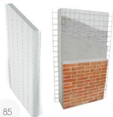
Ilustración 85. Esquema fachaleta sobre Emmedue. Fuente: [mdue.it](http://mdue.it)
