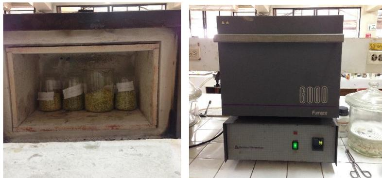
Figura 14: Secador usado en el proceso y algunas cáscaras sometidas a secado.
