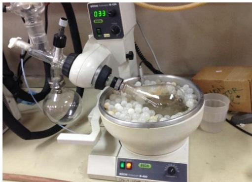
Figura 16: Rotavapor utilizado en la etapa de separación del proceso.
