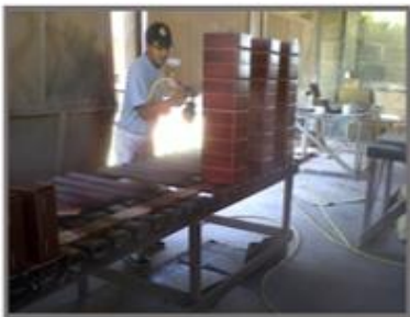
Personal sin equipos de protección usando barniz (Línea II)
