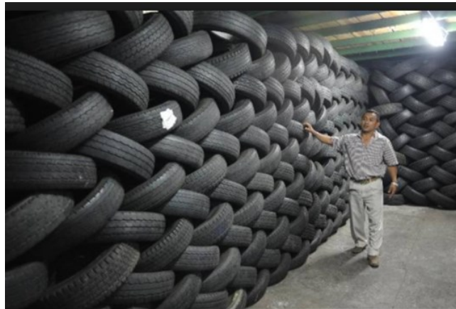
Ilustración 3-5. Método de entrelazado para el almacenamiento de llantas
