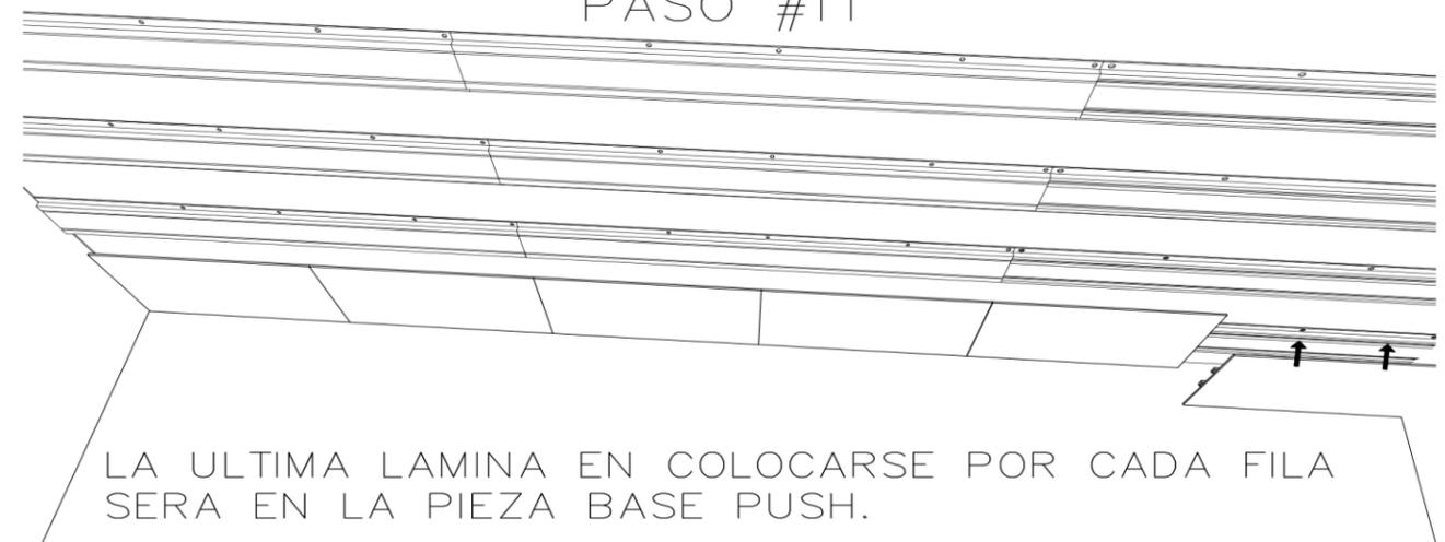
LA ULTIMA LAMINA EN COLOCARSE POR CADA FILA SERA EN LA PIEZA BASE PUSH.
