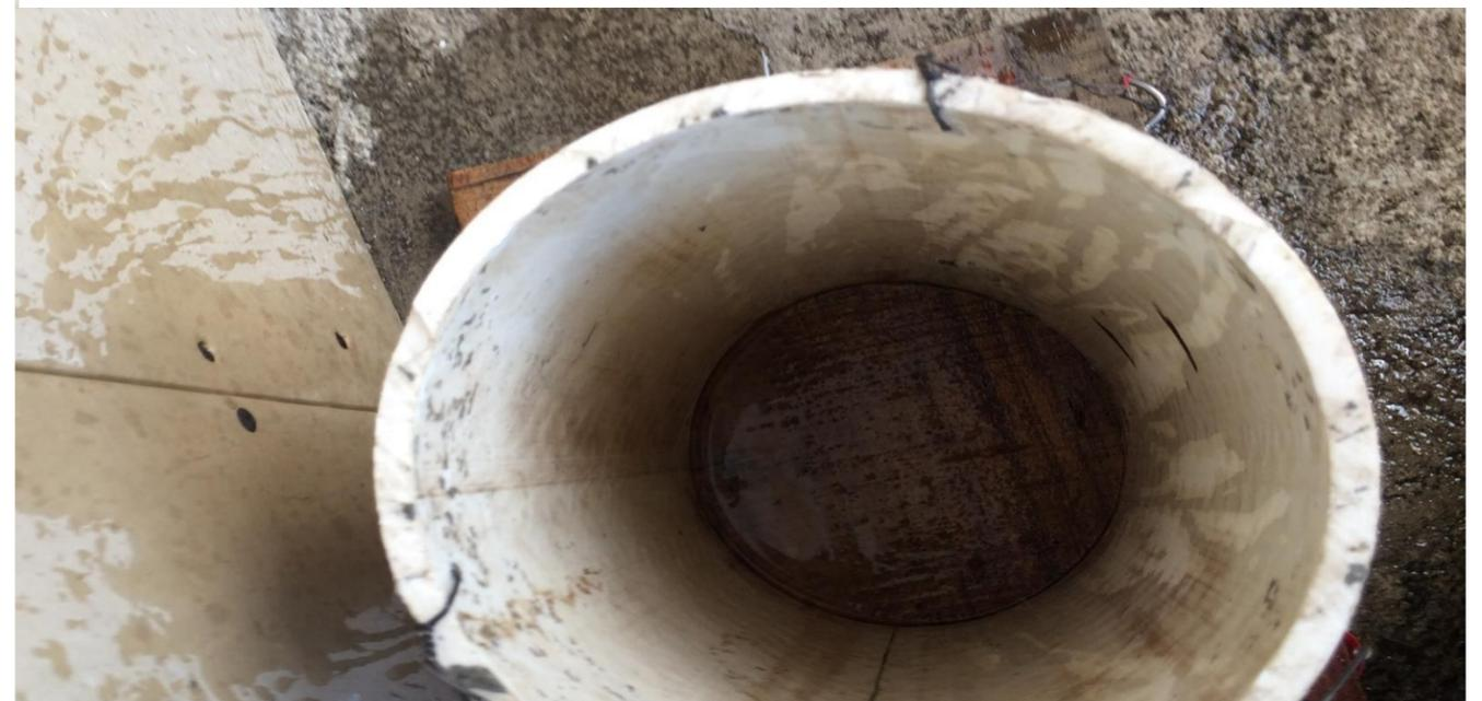
**IMAGEN No. 37** Concreto estructural 3000 Psi. Vista superior de cilindro de prueba de resistencia. Fuente: Autor.
