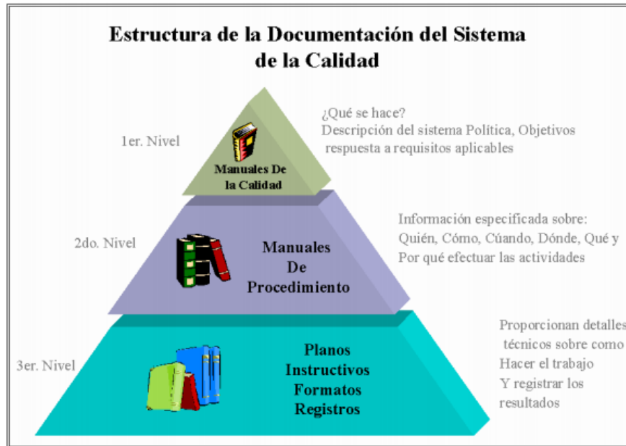
Ilustración 4: Estructura para la documentación de un sistema de gestión de calidad, bajo la norma ISO 9011.
