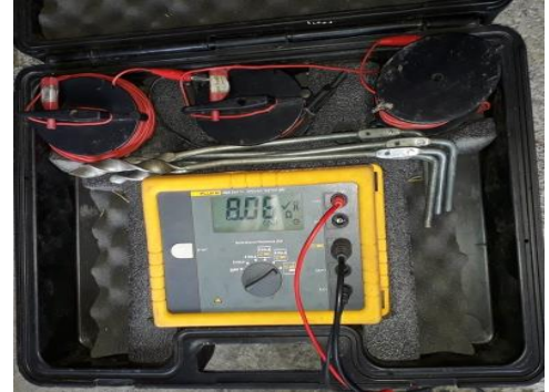
Segunda Medición 8.06 \Omega
