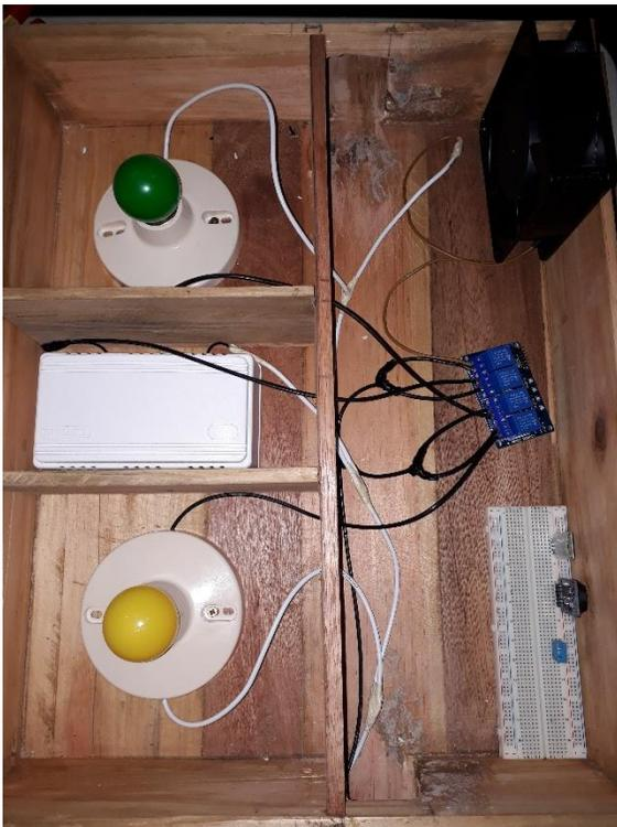
**Ilustración 63** Conexiones del módulo relé con los actuadores
