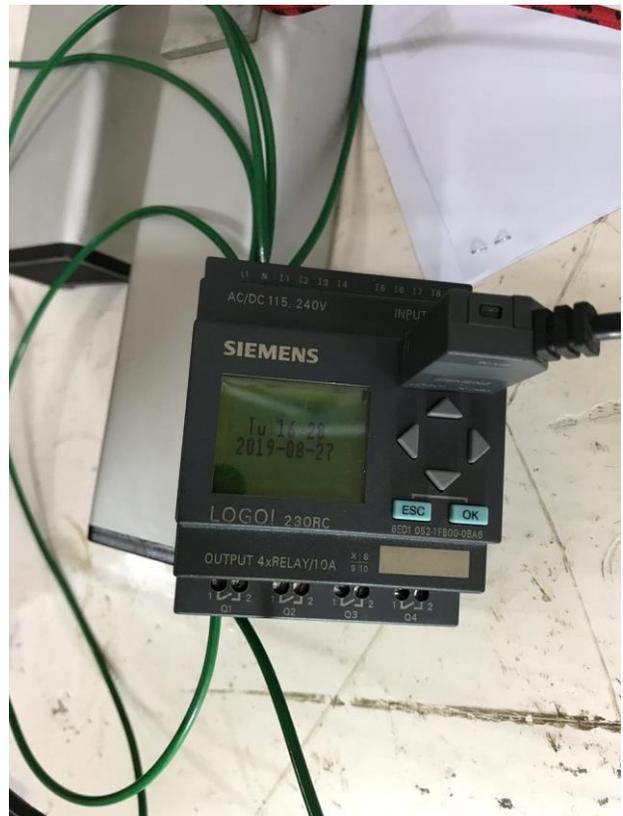
**Ilustración 66** Pruebas del subsistema control de iluminación exterior
