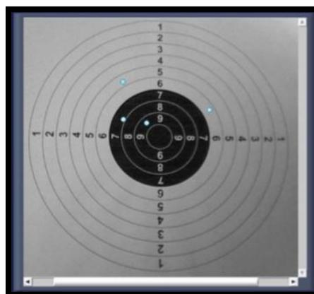
*Figura 1.4: Determinación de los puntos de impacto en un blanco usando visión artificial. Tomado de Enríquez & Ortega (2015)*
