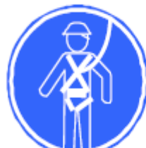
Protección Individual obligatoria contra caídas
