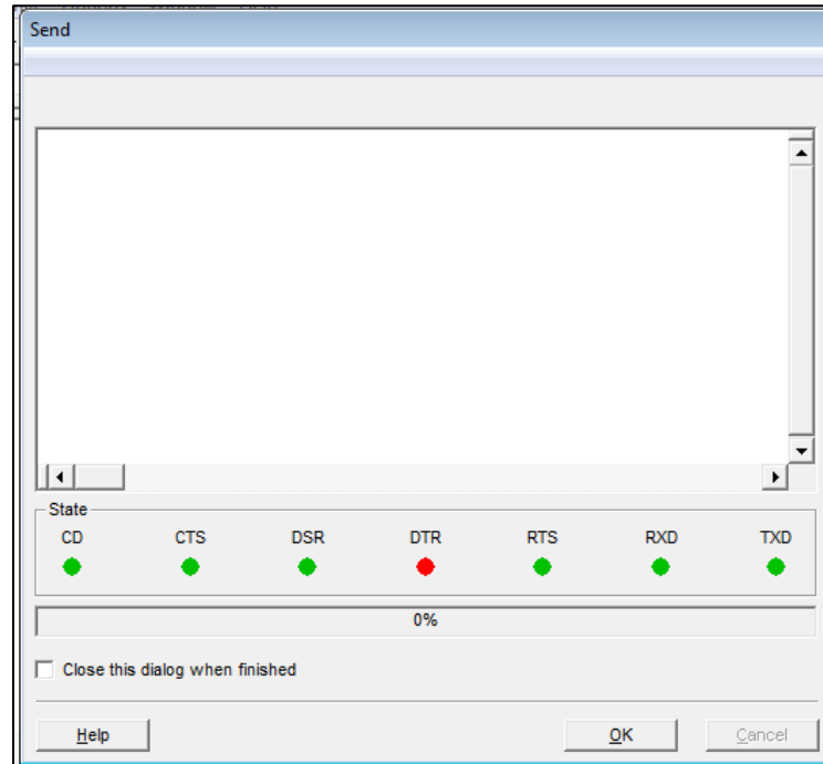
Fig.4.23 Interfaz del Predator editor. Pantalla para la transferencia o recepción de la Programación CNC
