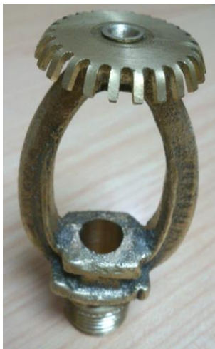
Ilustración 10: Rociador Grinnell Duraspeed - SSU-2 (Upright Sprinkler)
