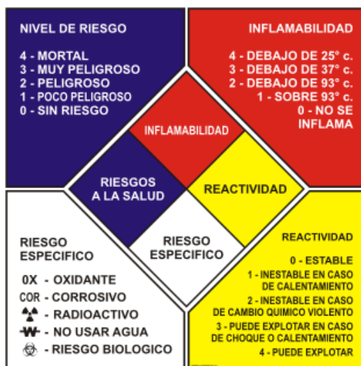
Ilustración 6: Etiquetado de Materiales Peligroso (NFPA 704)
