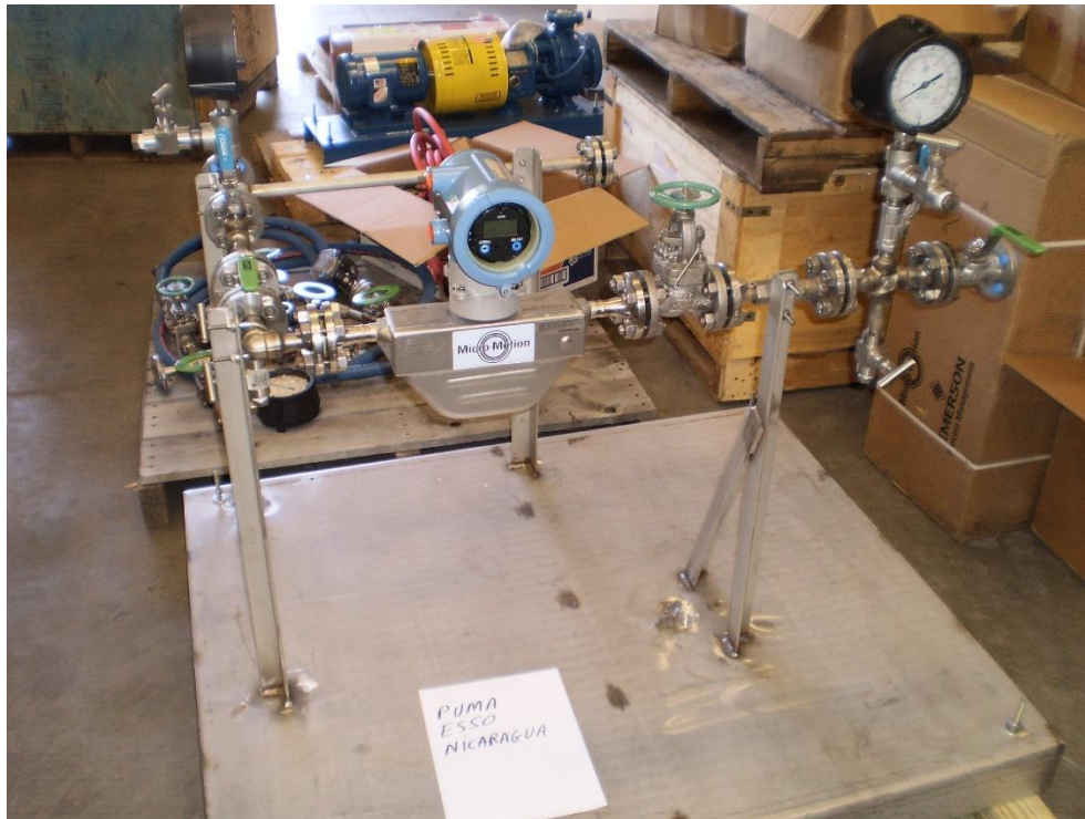
Ilustración 21: Nueva plataforma de medición (coriolis y accesorios)
