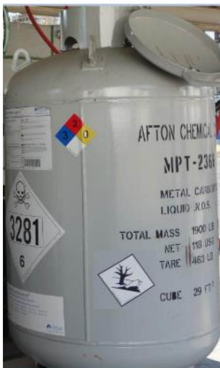
Ilustración 7: Rotulación de seguridad de cilindro MPT (UN3281, NFPA704)
