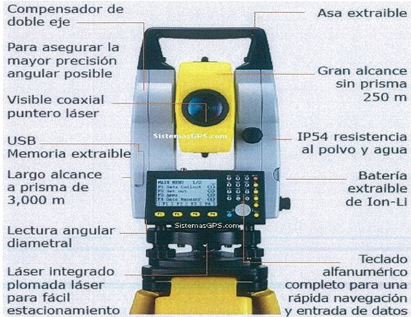
Figura 6: Partes de una estación total
