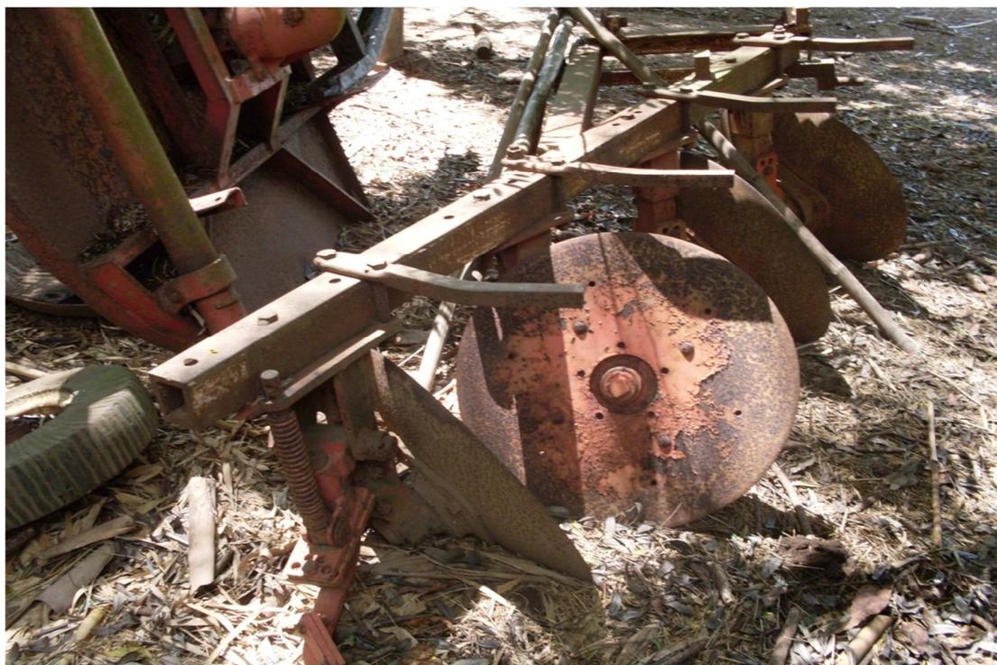
En esta figura se puede observar la condición de deterioro que presenta este arado de cuatro disco, tiene dañado en el cojinete de rueda guía y deterioro de la pintura producto de encontrarse a la intemperie.
