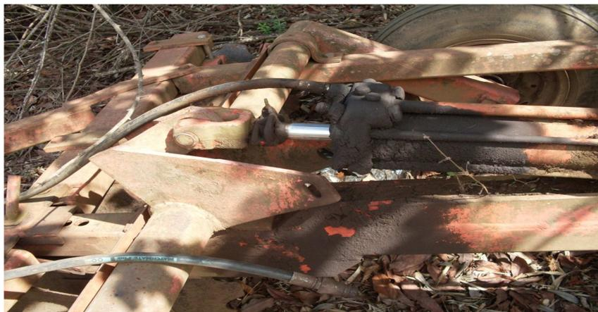
En las figura 4 y 5 puede observar dos equipos que se encuentran a la intemperie, el primero una sembradora cero labranzas en regular estado, Su estado físico no es muy bueno y tiene algunos componentes dañados, el segundo grada de 32 disco que presenta fugas en el sistema hidráulico. Dichas condiciones técnicas son un indicativo de falta de medidas preventivas para preservar el estado técnico de estos equipos. Estos poseen componentes sensibles a las condiciones climáticas adversas.
