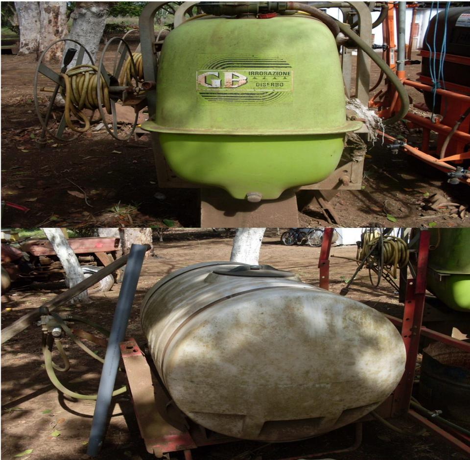
En esta la figura se presentan dos aspersores uno de 600 lit. Y otro de 150 lit. Ambos se encuentran en regular estado, el primero tiene dañado el depósito y las mangueras y el segundo requiere de boquillas. Todo esto Como consecuencia de no tomarse las medidas adecuadas de protección de estos equipos, ya que se encuentra a la intemperie y las condiciones climáticas tiene efectos adversos sobre algunos componentes que los conforman.
