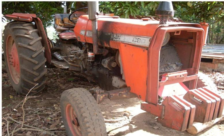
En la figuras 6 y 7 se muestran dos tractores en regular estado, el primero presenta problemas en el sistema eléctrico y arranque, por lo cual actualmente no se está haciendo uso de este valioso equipo, el segundo encuentra a la intemperie, el estado físico del tractor no es muy bueno y además presenta daños en sistema de embrague, asiento del conductor deteriorado y requiere de mangueras hidráulicas de dirección.
