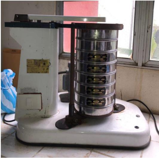
**Figura 12.** Tamices para clasificación granulométrica
