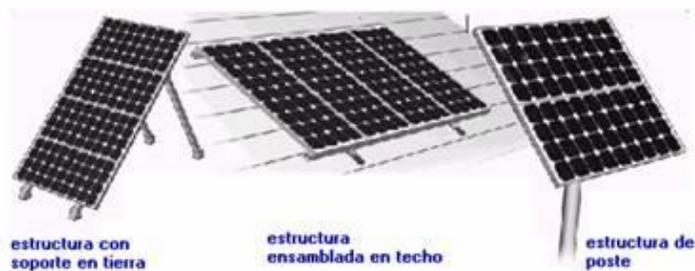
Figura 21: Estructuras de soporte para instalaciones fotovoltaicas.
