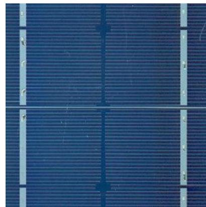
*Figura 5: Modulo de silicio monocristalino.*
