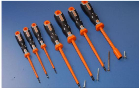
*Figura 36: Destornilladores para trabajos eléctricos.*
