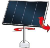
*Figura 24: Sistema de seguimiento por dos ejes.*
