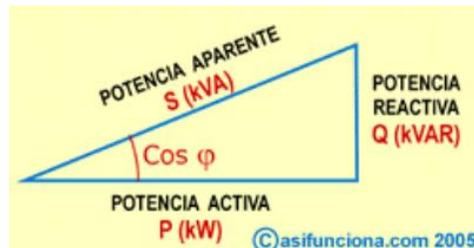
Figura 33: Triángulo de potencias.
