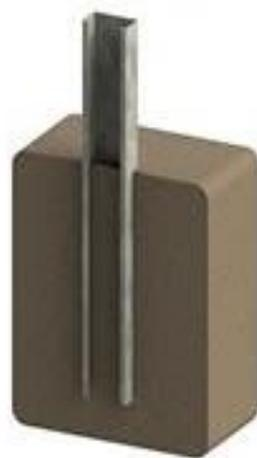
*Figura 25: Hincado directo de soportes de módulos fotovoltaicos.*
