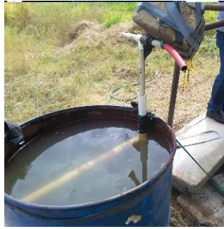
Figura 37. Peso añadido a la palanca triangular para simular condiciones de pozo
