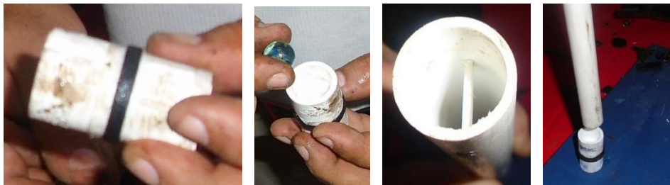
Figura 31. Proceso de construcción de válvula de pistón
