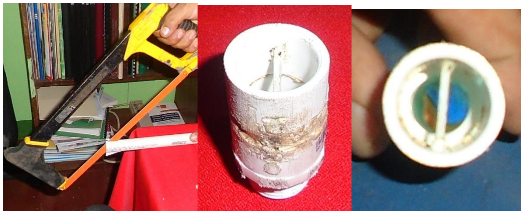
Figura 29. Válvula de pie construida
