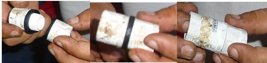
Figura 28. Válvulas de control de flujo (interna y externa)
