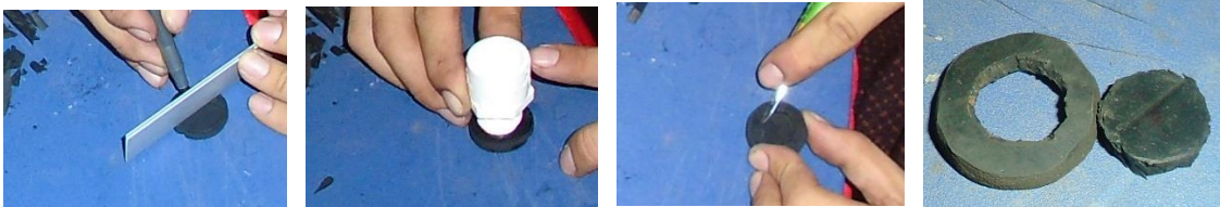
Figura 24. Cortes internos y externos del empaque
