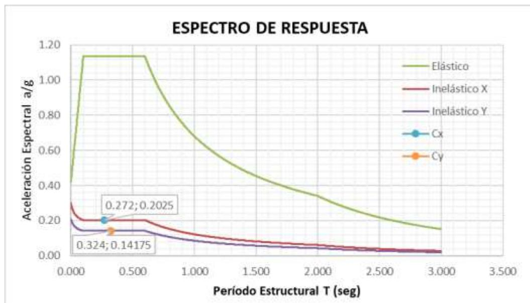
**Fig. 4.1 Espectro elástico con un amortiguamiento del 5% y aceleraciones máximas asociadas con un periodo de retorno de 2500 años.**
