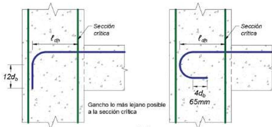
**Fig. 2.9. Esquema de anclaje de barras en unión viga-columna. (Eliud Hernández).**
