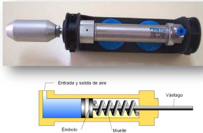
FIGURA 1-21. FOTO DE UN CILINDRO DE SIMPLE EFECTO RETORNO POR MUELLE.
