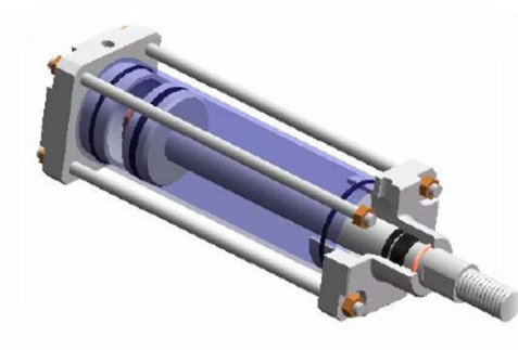
FIGURA 4-3. CAMARAS DE UN CILINDRO DE DOBLE EFECTO.
