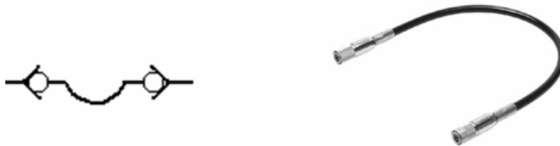
FIGURA 1-29.TUBO FLEXIBLE REAL Y REPRESENTACIÓN SIMPLIFICADA.
