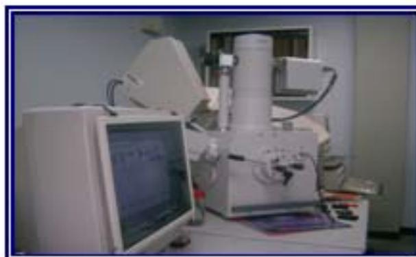
La Figura 2.9: Vista del casco exterior del microscopio electrónico de barrido (MEB) junto al procesador de datos
