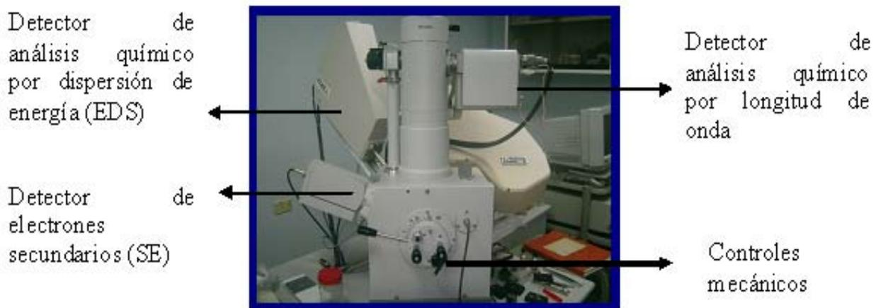
Figura 2.4: Partes del Microscopio Electrónico de Barrido (MEB)
