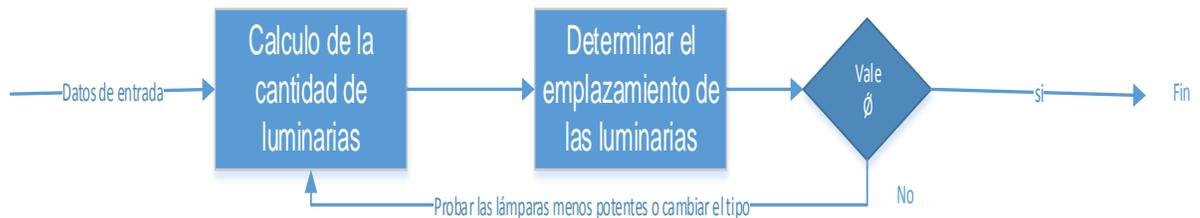
**Figura 15: Procedimiento realización diagrama de bloques**
