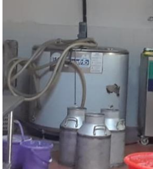
Figura 9. Tanque de enfriamiento
