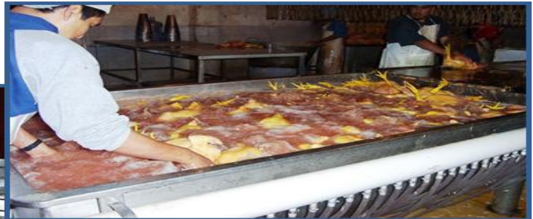
Tinas 100% Acero Inox. Con sistema de Agitación Revolvente, ajustable
