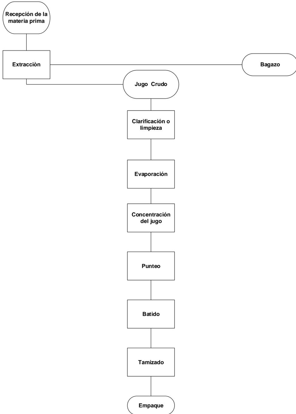
**Figura 11. Diagrama de proceso de la panela granulada**
