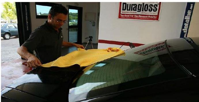
Para la técnica del posado, situaremos la toalla sobre la superficie y presionaremos en toda su extensión con la palma de la mano, de manera que será el efecto absorbente de la toalla el que se encargue de retirar el agua. De esta manera nos aseguraremos de realizar el proceso de secado sin ningún tipo de fricción.
